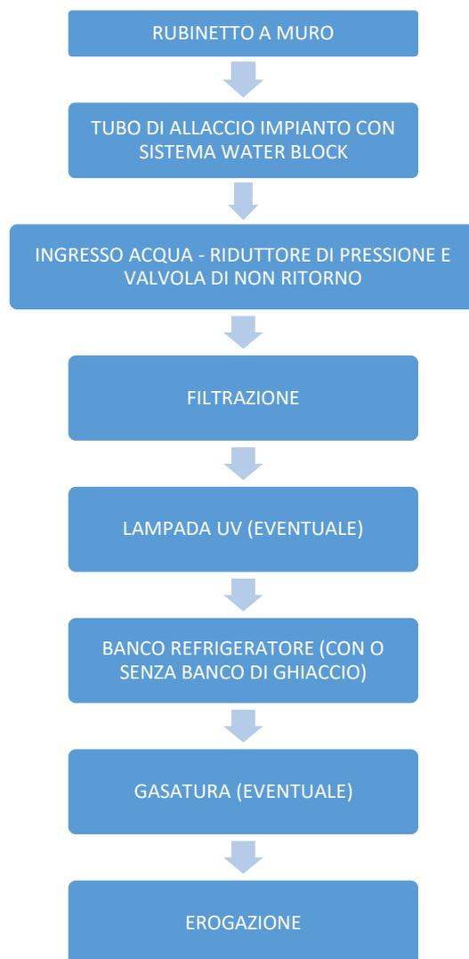
Di seguito viene fornita una sintetica descrizione delle componenti, ricordando come ognuna di esse debba rispondere al D.M. 174/2004 (per quanto relativo ai materiali) ed al D.M. 25/2012 (per quanto relativo all'impianto stesso).
